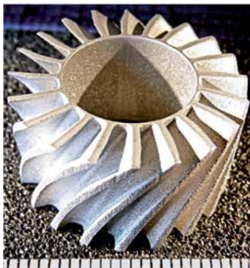
Fig. 21. A-Jet-machined aluminum blisk. Scale: mm.
