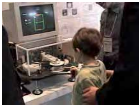
Fig. 25. Passive force display using ER brakes
