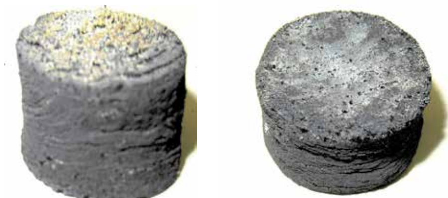
Fig. 14. Blocks of masteralloy Fe(TiMo)C
