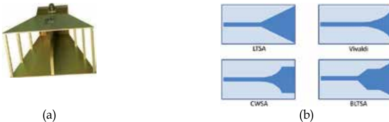
Fig. 2. (a) Horn Antenna – SA S571 A.H. Sys. Inc; (b) Tapered slot antennas.
