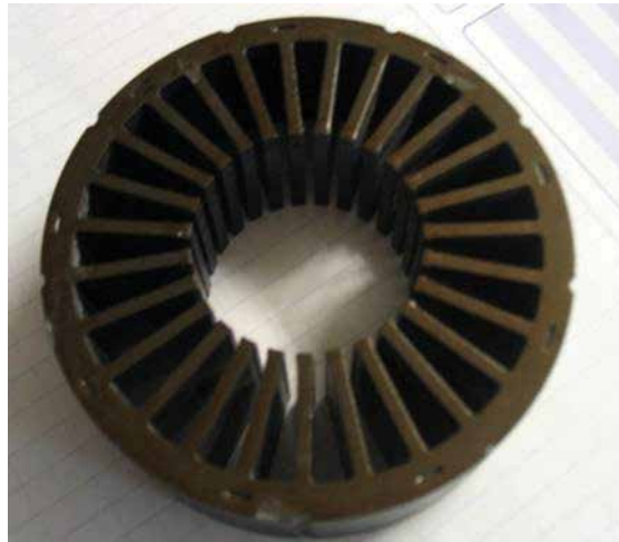
Fig. 8. EM stator assembled from thin metal plates
