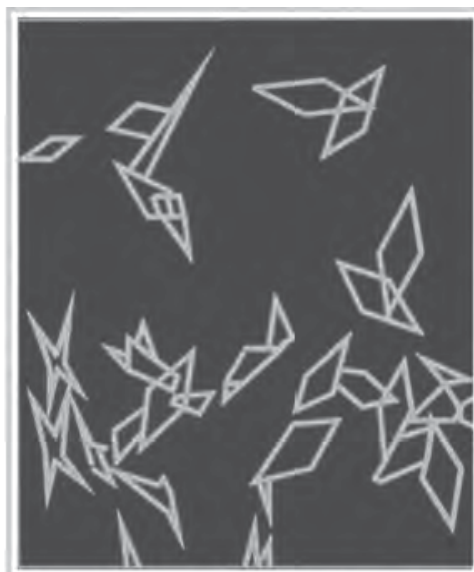
Crystal Morphology With Pour Point Depressant
