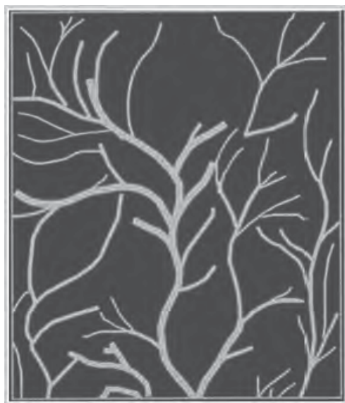
Crystal Morphology Without Pour Point Depressant
