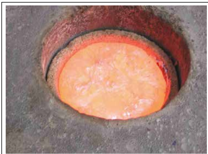
Fig. 26. Melted Aluminum load
