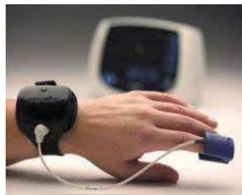
Fig. 11. Wireless Oximeter (Nonin (n.d)).
