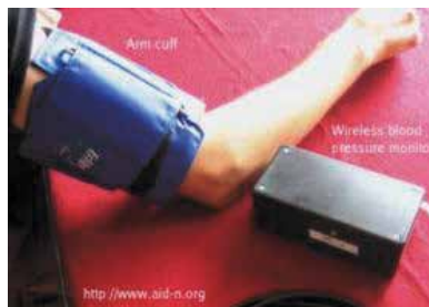
Fig. 10. Wireless blood pressure cuff (SunTech (n.d)).
