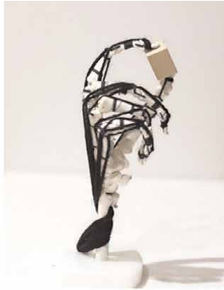
Palmar pinch grasp \varphi = [\varphi_1 \varphi_2 \varphi_3^{max} \varphi_4^{max} \varphi_5^{max} \varphi_6 \ 1]^T
