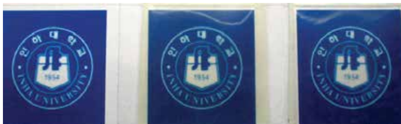
Fig. 11. Visual appearance of TPU/O-MMT nanocomposite films: a) TPU, b) TPU/3wt%O-MMT, c) TPU/5 wt% O-MMT.
