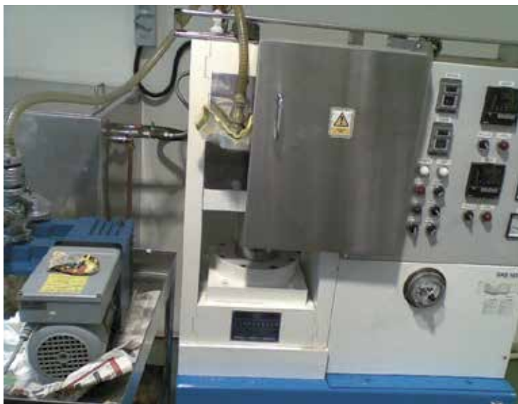
b) Actual hot press setup
